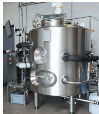
Réacteur de dépolymérisation de déchets plastiques et textiles PET en monomères de l'unité Pilote de CARBIOS.
