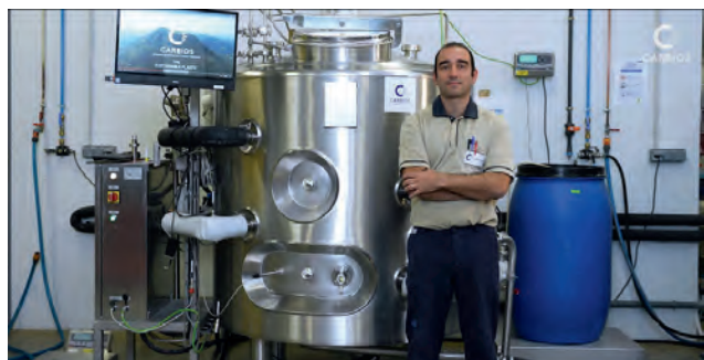
Réacteur de dépolymérisation de déchets plastiques et textiles PET en monomères de l'unité pilote de Carbios.
