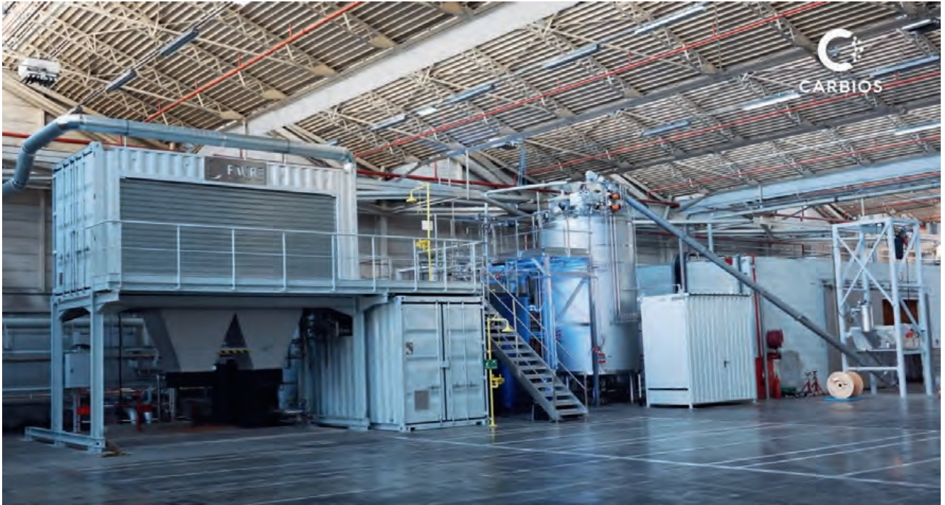
Démonstrateur industriel Carbios pour la dépolymérisation des déchets plastiques et textiles PET en monomères. (Carbios)
