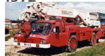
GB18 Haulotte, première «City crane» au monde - vitesse élevée de déplacement, mise en oeuvre rapide et cabine élévatrice.
