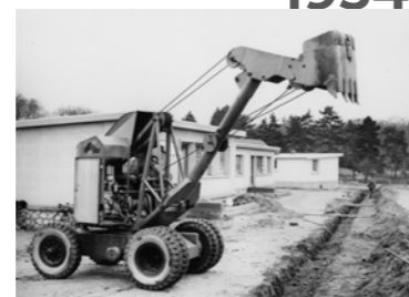
Pelle compacte SK2 Pinguely - Première pelle compacte au monde sur pneumatique sans dépôt arrière.
