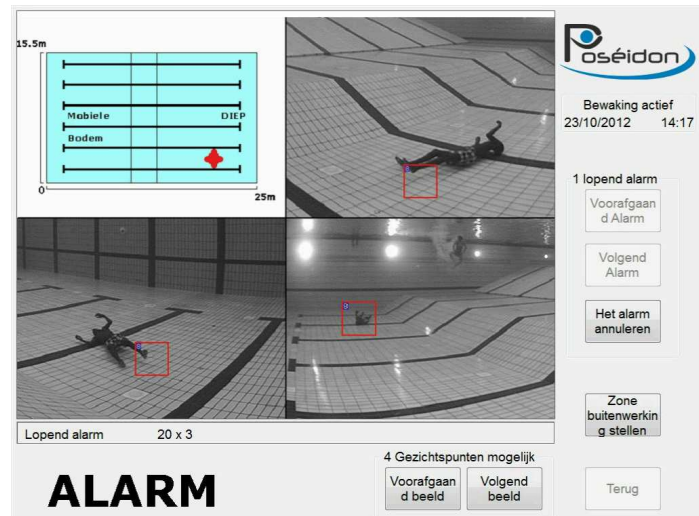
Interface du système Poséidon lors de la détection d'une noyade
