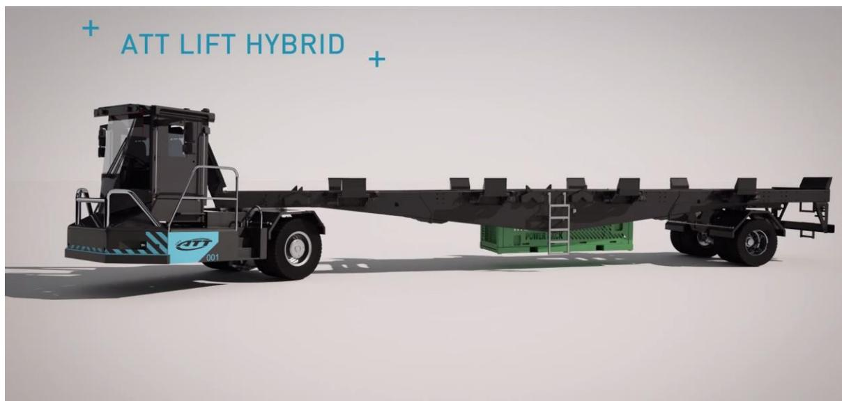
ATT HYBRID utilise des moteurs électriques situés dans les roues offrant le meilleur couple au démarrage et permettant de récupérer l'énergie cinétique générée au moment du freinage pour un gain de 20 %.
