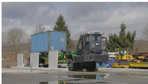
L'ATT LIFT, avec chauffeur et cabine, se lève pour enlever le container (en bleu) de la DSSC (en gris clair). L'AIV LIFT sans chauffeur est déjà en attente, positionné sous la DSSC (en gris clair), elle-même enjambée par le Straddle Carrier qui s'engage pour déposer le container (en bleu).
