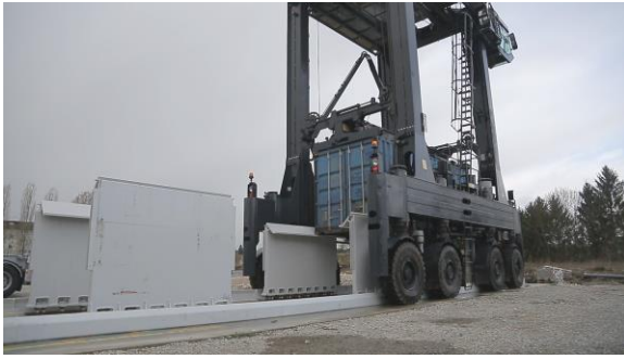
Le straddle Carrier (en gris foncé) enjambe la DSSC (en gris clair) pour déposer le container (en bleu) sur la DSSC.
