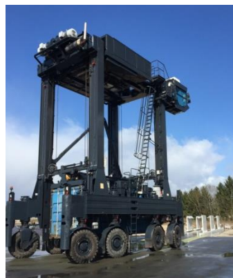
Straddle Carrier (en gris foncé) en pose ou dépose de container (en bleu) sur le sol ou sur la DSSC (en gris clair).
