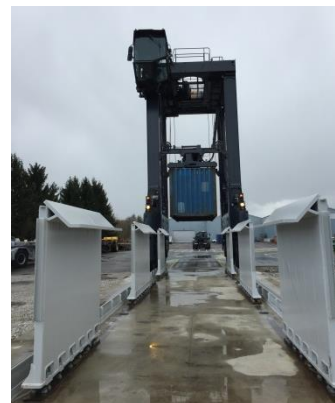
Straddle Carrier (en gris foncé) en pose ou dépose de container (en bleu) sur le sol ou sur la DSSC (en gris clair).
