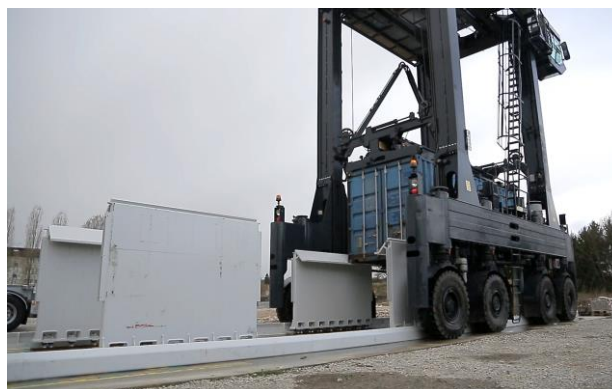
Le straddle Carrier (en gris foncé) enjambe la DSSC (en gris clair) pour déposer le container (en bleu) sur la DSSC.
