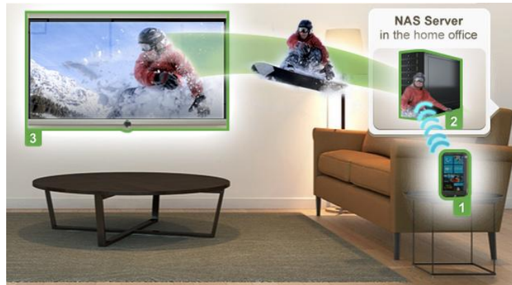
Figure 1 - Exemple d'usage DLNA : la lecture d'un film sur votre disque dur connecté, en le découvrant automatiquement depuis votre smartphone (1 et 2) pour le lire sur la télévision (3). Plus de 3 milliards d'appareils sont certifiés DLNA.
