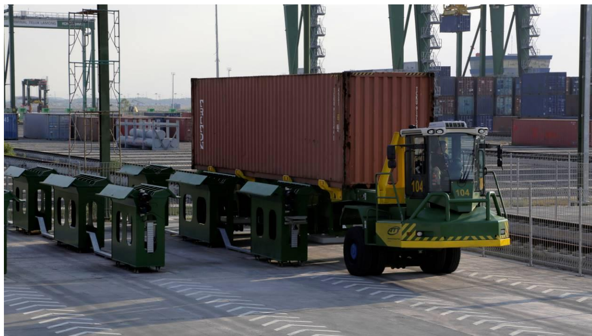
ATT LIFT en mode automatique déposant un container dans la Docking Station
