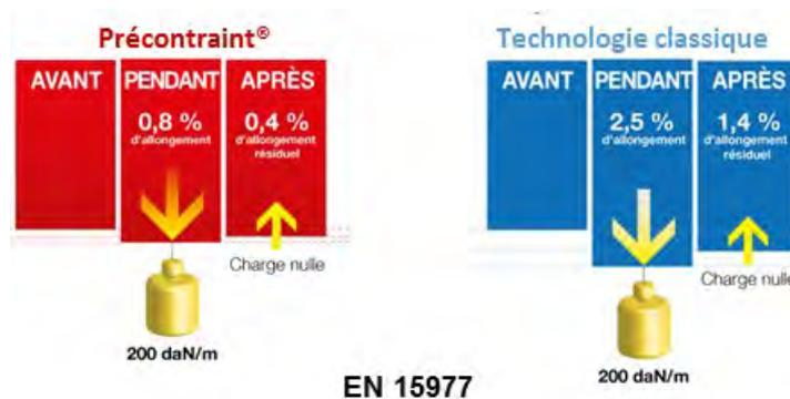
La durabilité et la résistance à la traction des matériaux Serge Ferrari sont illustrées par des utilisations sur le long terme, avec une stabilité des performances :
