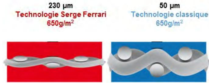
En outre, l'homogénéité du traitement de surface procurera au matériau une efficacité accrue en termes de protection contre la lumière et les UV, ainsi que contre les intempéries et l'usure. Ces caractéristiques d'efficacité et de durabilité accrues seront particulièrement importantes pour certains secteurs d'application, notamment dans l'architecture, à la fois au moment de l'installation mais également à l'usage pendant toute la durée de vie du produit (jusqu'à 30 ans).
