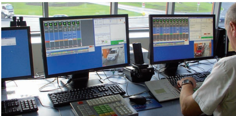
Supervision et assistance à distance par un seul opérateur de plusieurs gares et de plusieurs dizaines de voies automatiques.
