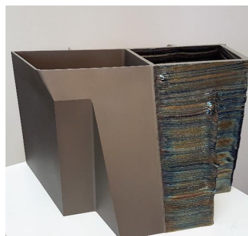
Coffre en titane TA6V réalisé avec la technologie RAF. Marché : défense
