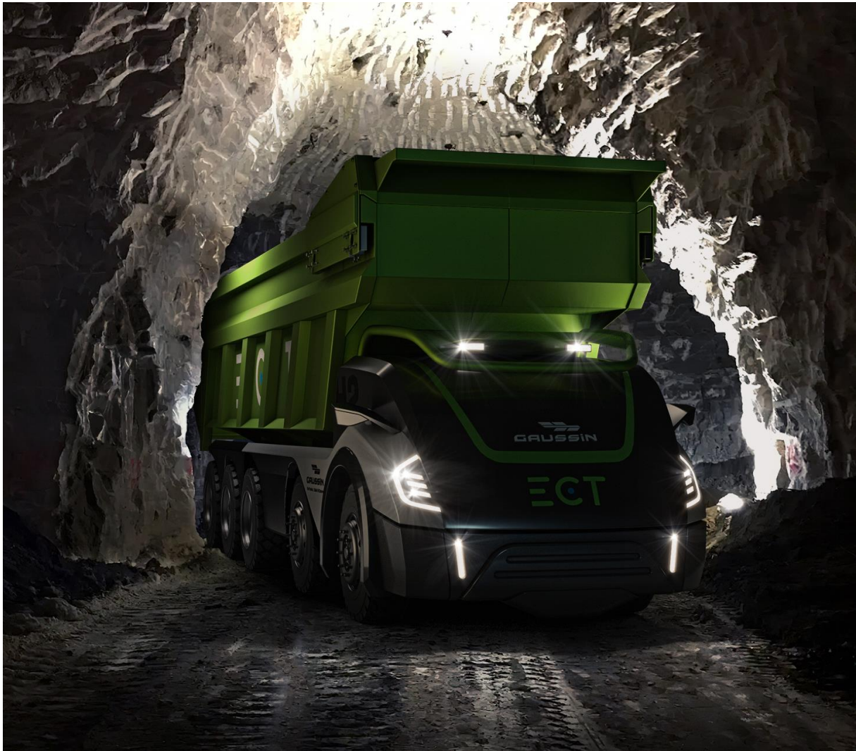
Porteur sans cabine 10x4, autonome, 70 tonnes, autonomie 10h, 40 km/h, puissance 420 Kw
