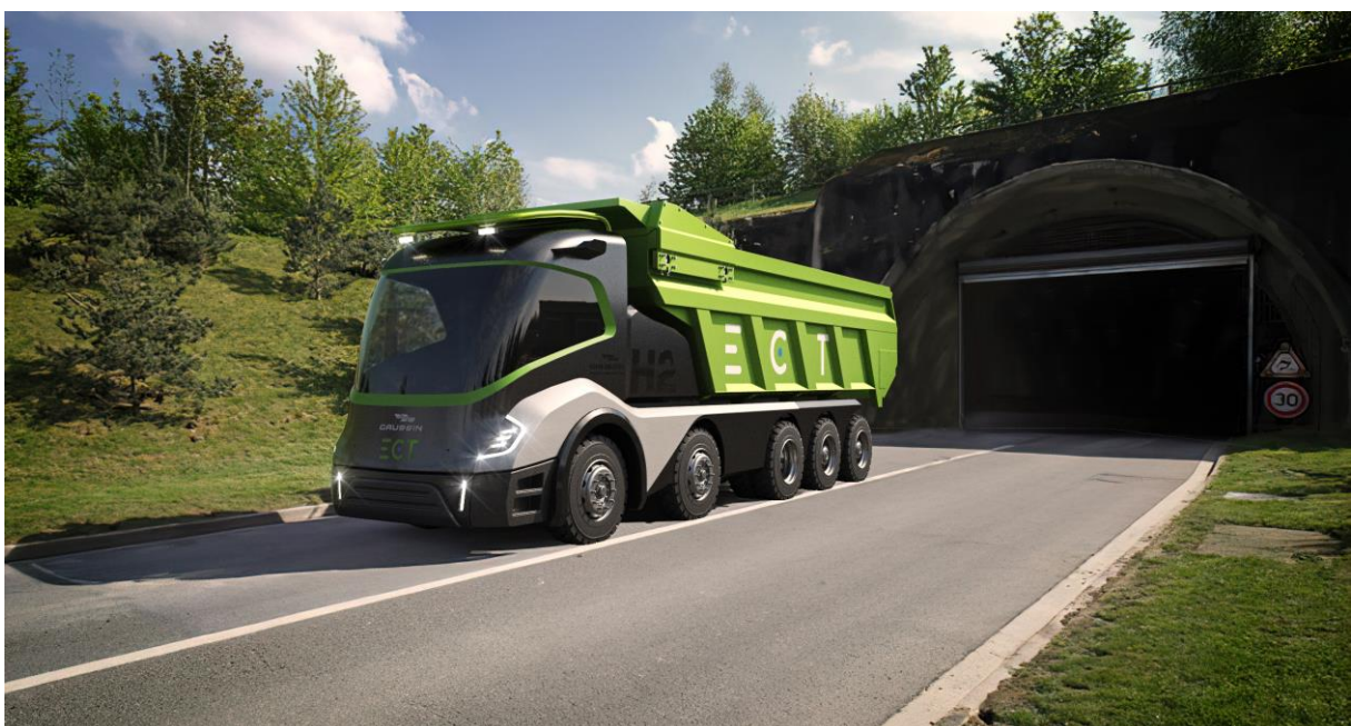
Porteur 10x4, 70 tonnes, autonomie 10h, 40 km/h, puissance 420 Kw
