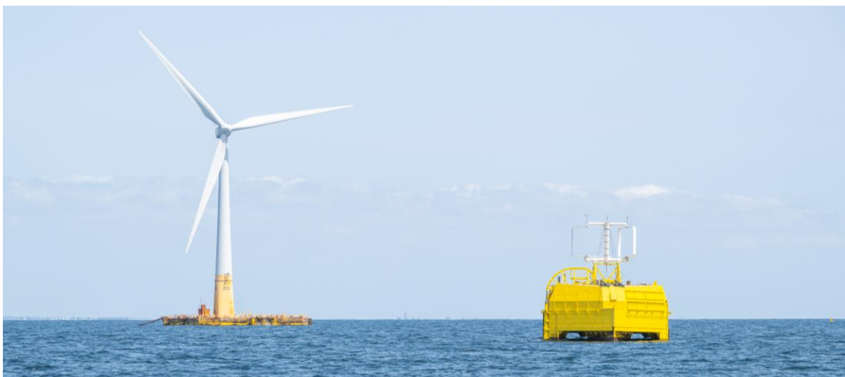
Légende : à droite : Sealhyfe, pilote de production d'hydrogène offshore (Lhyfe), sur la plateforme WAVEGEM (GEPS Techno), A gauche : turbine flottante FLOATGEN (BW Ideol). Sur le site d'essais en mer SEM-REV (Centrale Nantes / OPEN-C) ©Lhyfe
