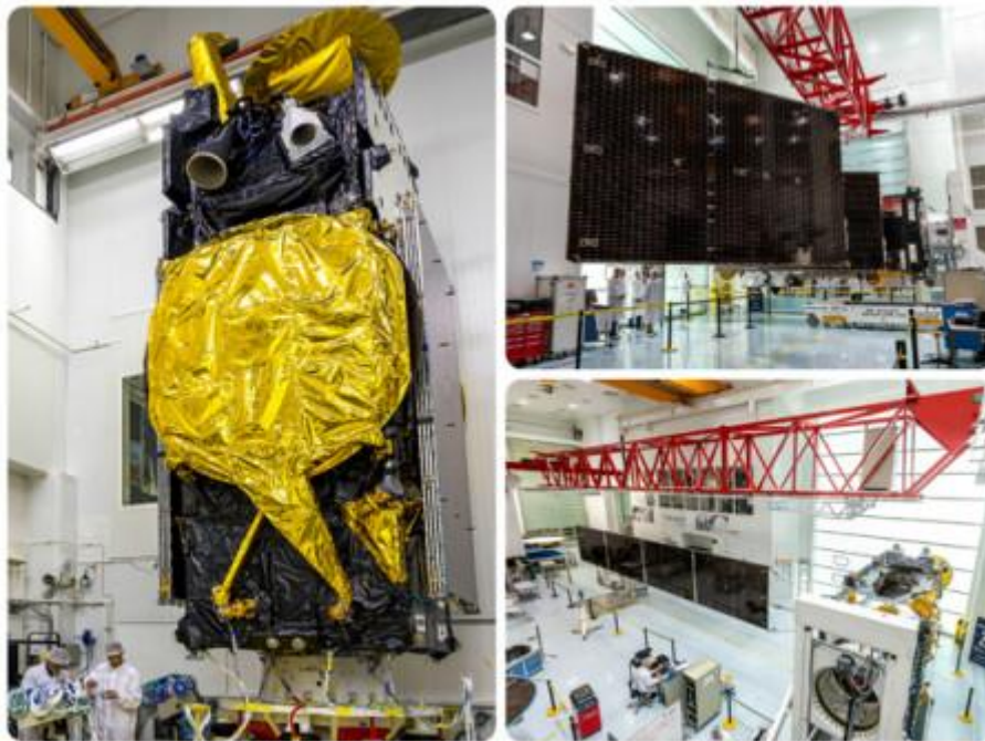
Essais de vibration (à gauche). Le satellite « s'étire » (à droite) lors du déploiement de ses panneaux solaires.
