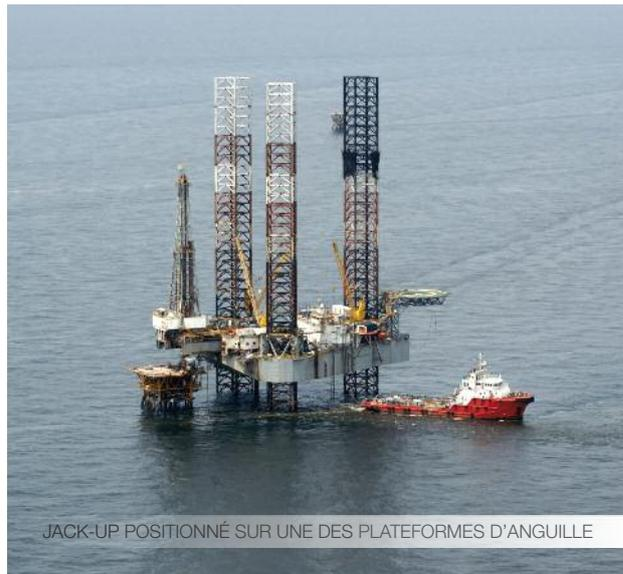
JACK-UP POSITIONNÉ SUR UNE DES PLATEFORMES D'ANGUILLE
