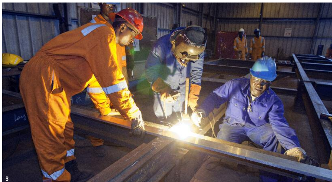
1 | Travaux d'installation du jacket d'AGMN – 2 | Plateforme Torpille – 3 | Préfabrication de structures de la centrale électrique de PG2 ▼
