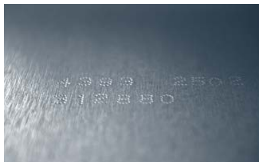
↑ Marquage sur une tôle
