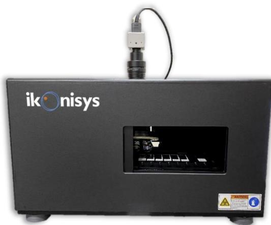
La Plateforme Ikoniscope20 est une solution de diagnostic **entièrement automatisée** et disponible sur le marché pour la détection, l'analyse et l'interprétation de cellules rares, qui comprend un microscope numérique et ses applications de diagnostic logicielles propriétaires. L'Ikoniscope20 est **approuvé par la FDA et marqué CE**.
