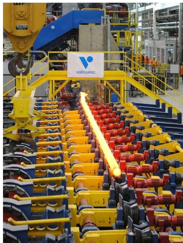
© Vallourec. / Laminage d'un tube dans la nouvelle usine de Vallourec à Youngstown, Ohio
