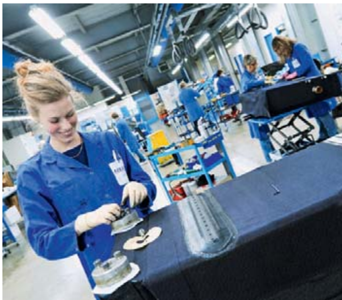
Confection d'un réservoir anti-crash pour les hélicoptères Super Puma AS332.
