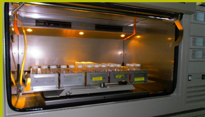
Incubateur CO<sub>2</sub> « Kuhner » pour la production de quelques mg d'anticorps destinés à être purifiés sur robot.
