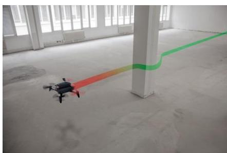
**Parrot S.L.A.M.dunk**, d'un poids inférieur à 140g (< 4,9oz), s'adapte sur divers types de drones et plateformes robotiques sous Linux (drones et ailes volants, robots ou drones roulants, bras articulés...) grâce à un kit d'attaches fourni
