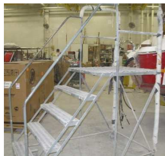
Plateformes mises en place en remplacement des escabeaux – Usine de Cadillac (USA)
