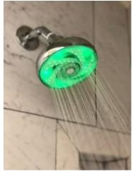
Il s'agit du premier déploiement d'envergure au monde d'un réseau LoRa® de douches communicantes, qui indiquera en temps réel aux clients de HI USA la quantité d'eau qu'ils utilisent pour se doucher, grâce à une séquence de LEDs colorées (comme un feu de signalisation).
