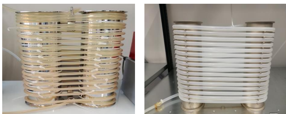
Figure 26 : Schéma du processus de décantation, le décanteur expérimental et le prototype.
