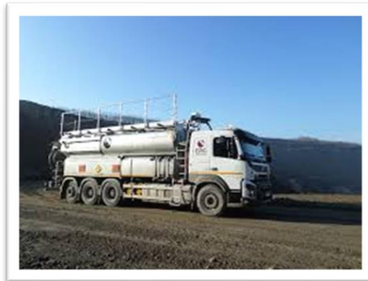
Photo d'une UMFe (source : site internet d'EPC Belgique)
