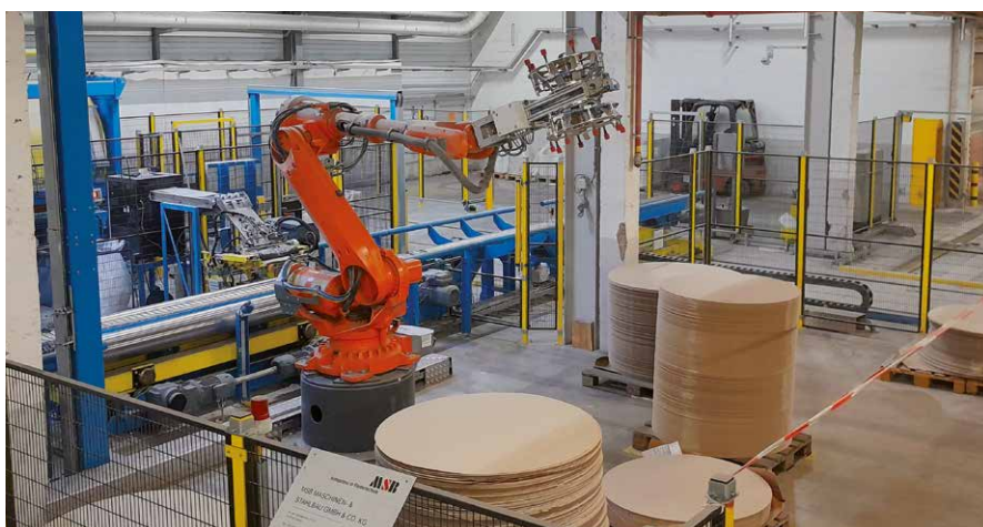
Papeteries de Clairefontaine - Robot de pose automatique de disques en carton
