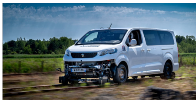
Le véhicule rail-route Ferromobile validé pour essais sur voie ouverte
