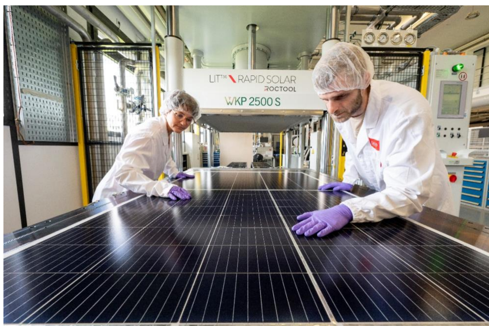
Équipement de thermocompression LIT™ RAPID SOLAR, développé en partenariat avec la société Roctool Crédit CEA - Laurence GODARD
