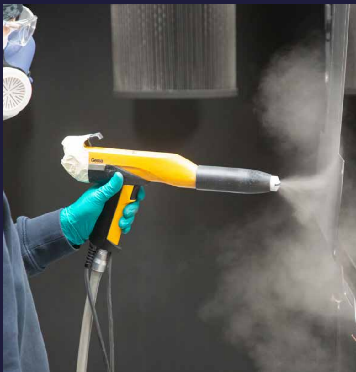
ALTHEORA Coating -Site de Mauves Application peinture poudre
