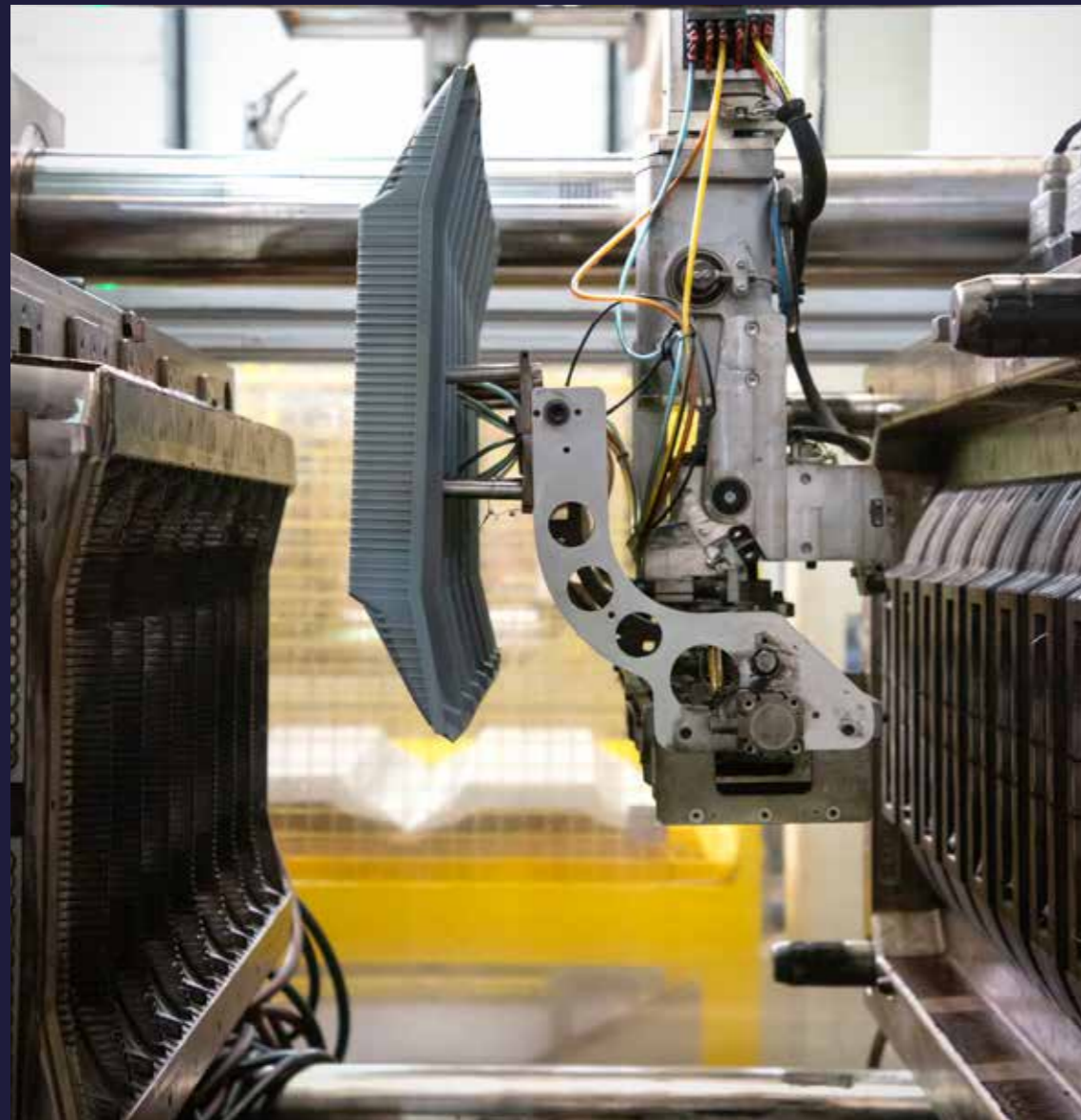
ALTHEORA Injection - Site d'Oyonnax Presse Injection 2 300 tonnes
