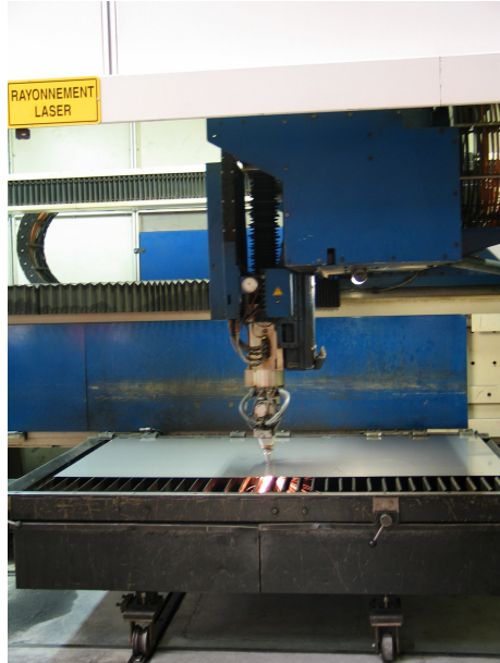
Le laser de découpe Usine de Vire
