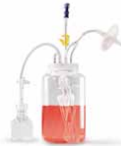
SuperSpinner D 1000 Bioréacteur à usage unique à l'échelle 1 l pour la production rapide et économique de protéines recombinantes, d'anticorps monoclonaux ou de biomasse
