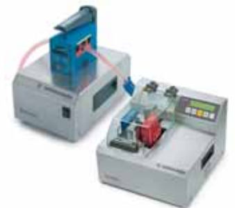
BioSealer® | Biowelder® Appareils entièrement automatisés pour la connexion et la déconnexion stérile de tuyaux thermoplastiques sur des systèmes de poches à usage unique
