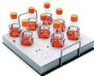
SENSOLUX® Table d'agitation, équipée de capteurs optiques, destinée à la culture cellulaire. Utilisée avec des fioles Erlenmeyer, elle permet une mesure non invasive des valeurs de pH et de pO2 dans les agitateurs d'incubation
