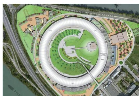
Cette extension permettra à l'ESRF de répondre aux objectifs scientifiques des 20 prochaines années et en particulier en matière de nanotechnologies (10-9 m). Les "lignes de lumière", qui sont les faisceaux de rayons X du microscope, atteindront une longueur de 110 m à 140 m au lieu des 60 m à 80 m actuels.
