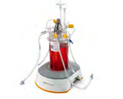
UniVessel® SU Cuve à usage unique de petite capacité pour la culture de cellules avec capteurs optiques intégrés pour mesurer le pH et l'oxygène
