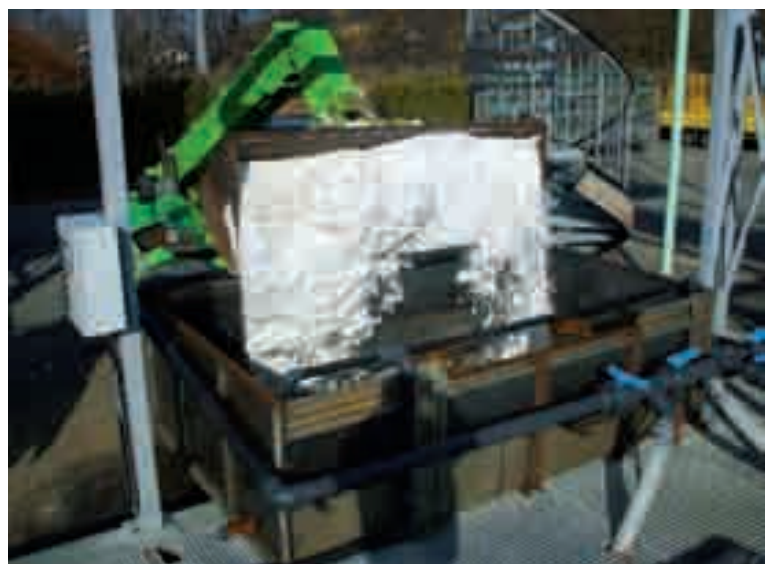
APRR remplace le gros sel par de la fine de sel (résidu naturel du processus industriel d'une usine proche du site de fabrication de la saumure) pour le traitement hivernal du réseau autoroutier en Combe de Savoie (Alimentation en fine de sel du bac de fabrication de la saumure).
