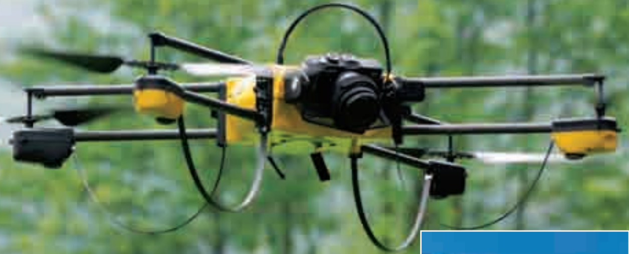
Le drone photographie et filme en haute définition des ouvrages difficiles ou impossibles d'accès [Eiffage Énergie].
