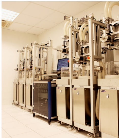
Source CARMAT - Salle d'endurance des systèmes complets, pouvant accueillir jusqu'à 12 systèmes en environnement contrôlé.
