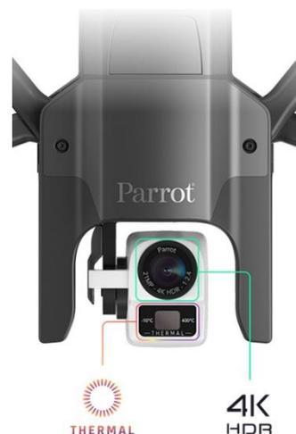
Les images du visible et de l'invisible peuvent être fusionnées en direct par l'application **FreeFlight 6**. Chaque élément de l'environnement apparaît alors précisément avec, en surimpression, la représentation des fuites thermiques ou les différences de température.
