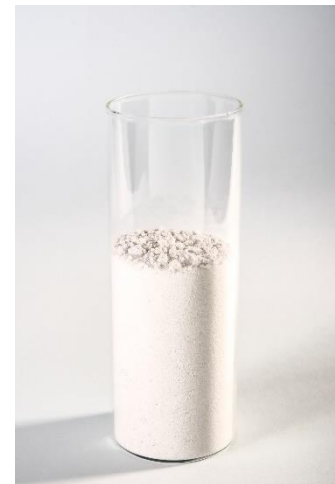
Figure 2 : PTA issu du processus de biorecyclage du PET de CARBIOS
